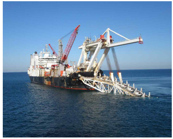
터키스트림 해상구간 파이프라인 설치하는 선박 Audacia (출처: 가즈프롬)
